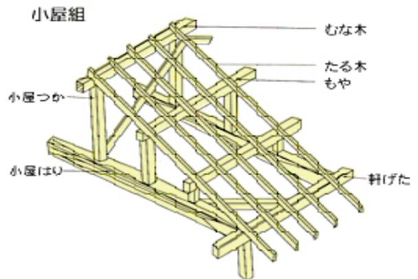
せて拝むしぐさ。② 建築で、二つの材を山形に組み合わせた構造。
