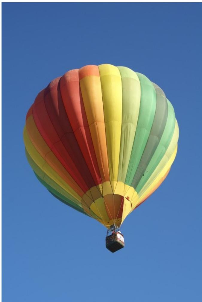
熱気球と同様の乗り物にガス気球というものもある。浮力をどの気体によって得るのが熱気球とガス気球の大きな違いである。暖められた空気はその周りの空気より軽くなるので、それを使うのが熱気球である。ガス気球は空気より軽い水素ガスやヘリウムガスによって浮力を得ている。
